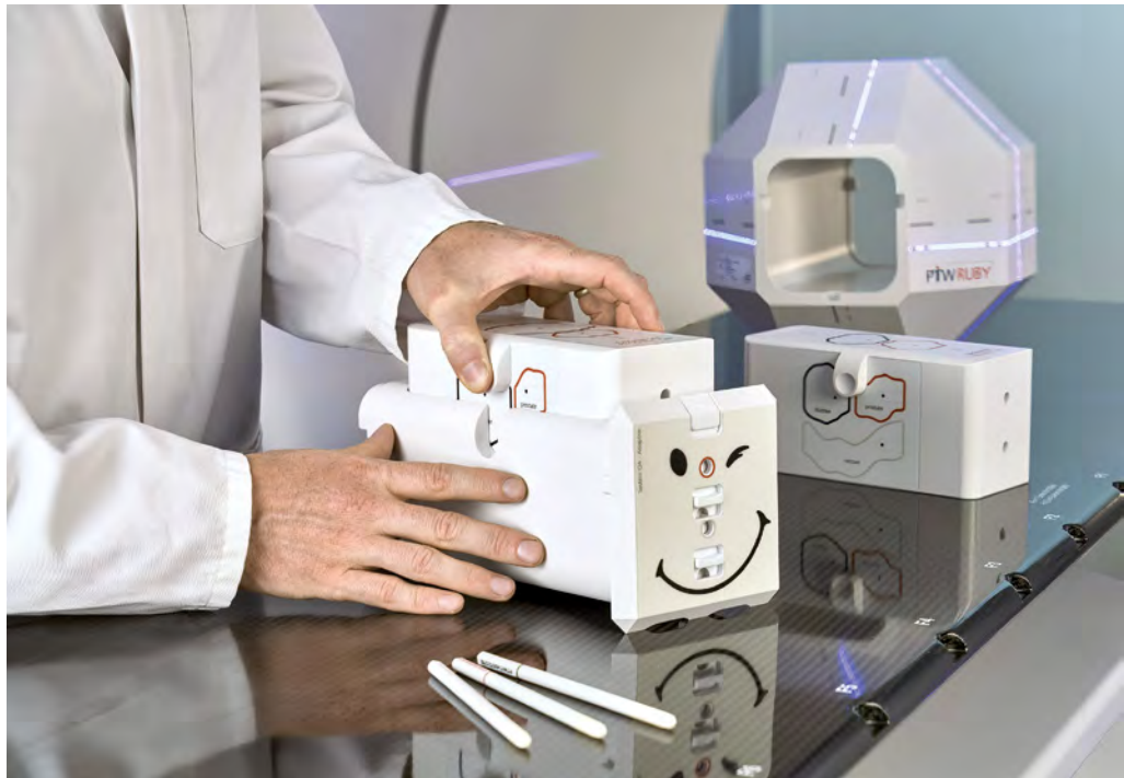
Mit einem End-to-End-Phantom wie Ruby lassen sich der klinische Workflow und die gesamte strahlentherapeutische Behandlungskette prüfen.
