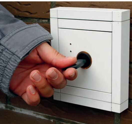
Der batterieless arbeitende blueSmart-Schlüssel trägt einen neuen, intelligenten Chip im Inneren eines IP68-tauglichen Kunststoffgehäuses. Mit ihm überträgt das System Informationen schnell und kabellos vom Access Point (li.) zu und zwischen den elektronischen Zylindern (Mitte) und den Standalone-Lesern (re.).
