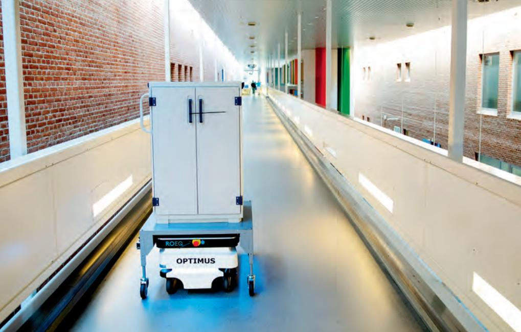
Dank hochmoderner Sensortechnologie navigieren die Roboter selbstständig durch die Krankenhausflure. Auch elektrische (Sicherheits-)Türen können sie selbstständig öffnen und in Aufzüge ein- und aussteigen.
