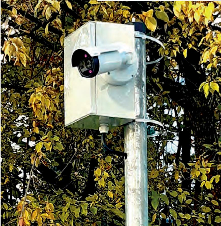
Bei der automatischen Nummernschild-Erkennung (ANPR) wird das Kennzeichen über Kameras erfasst.
