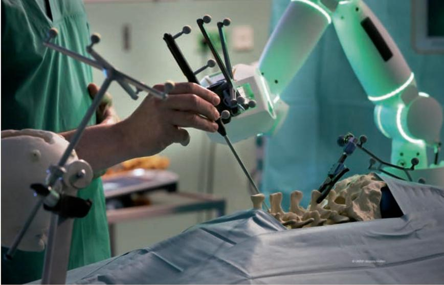
Leuchtet der Roboterarm grün, so ist die bestmögliche Position erreicht und der Operateur kann Schrauben und Drähte setzen.
