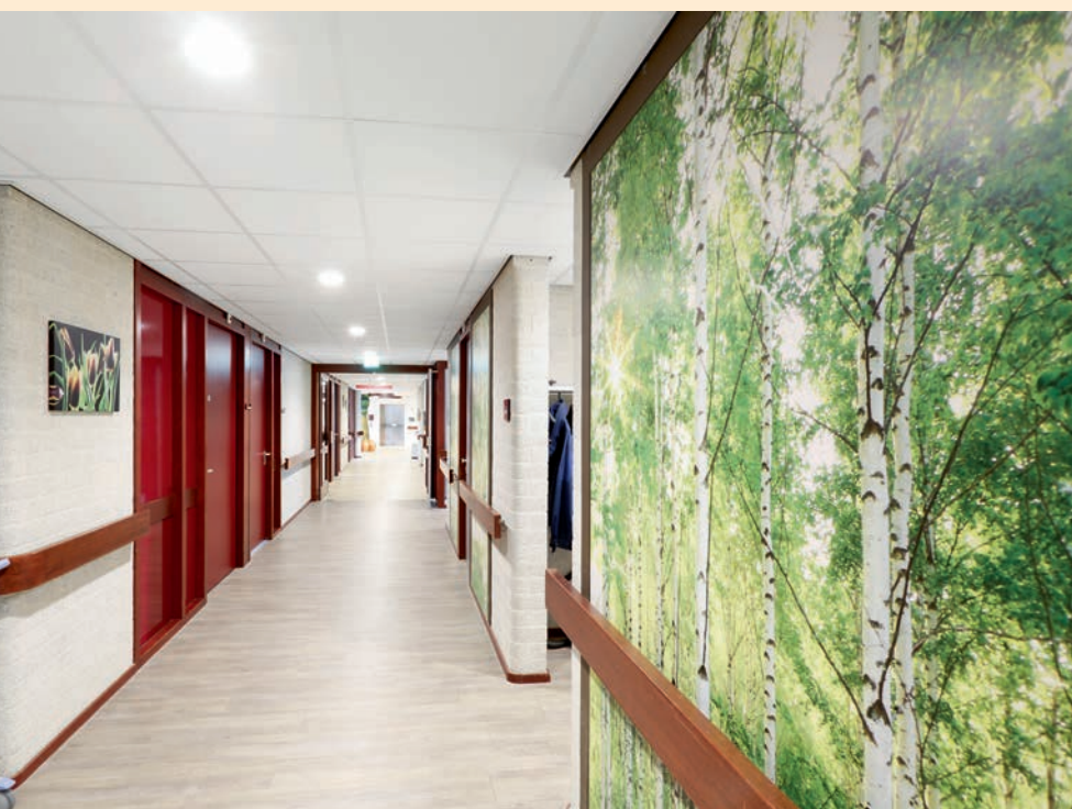
Flurgestaltung, Handlauf und Türen heben sich kontrastreich von der Wand ab. Der Wandschutz mit Fotodruck lockert den langen Flur auf und schafft Orientierung.
