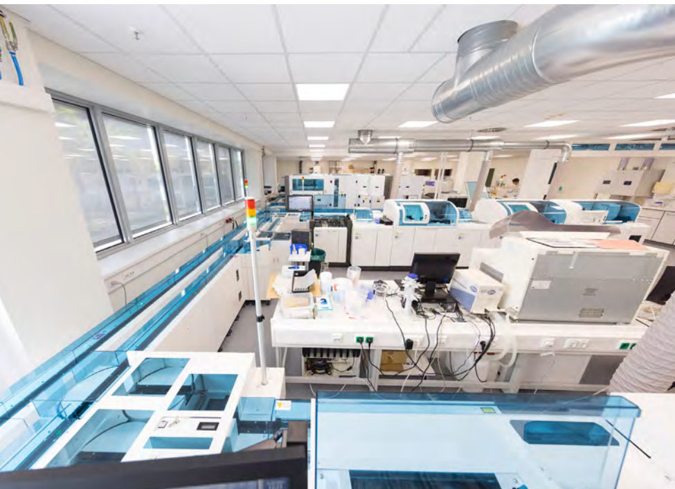
Zentrallabor der Mühlenkreiskliniken: Die Laborstraße wurde von Grund auf neu aufgebaut und strukturiert. Auf den beiden Hauptsträngen (li.) laufen die Proben vollautomatisch durch den Maschinenpark.
