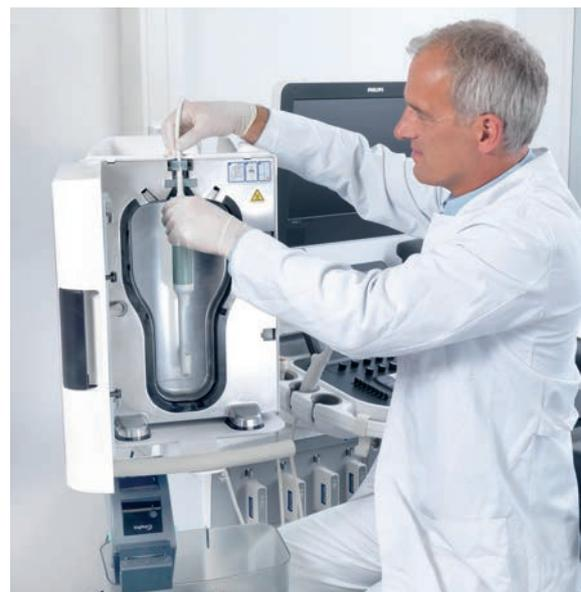
Mit dem trophon EPR können Ultraschallsonden durch eine automatisierte und validierte viruzide (High-Level)-Desinfektion nach RKI/DVV 2012 aufbereitet werden. Bild: Miele
